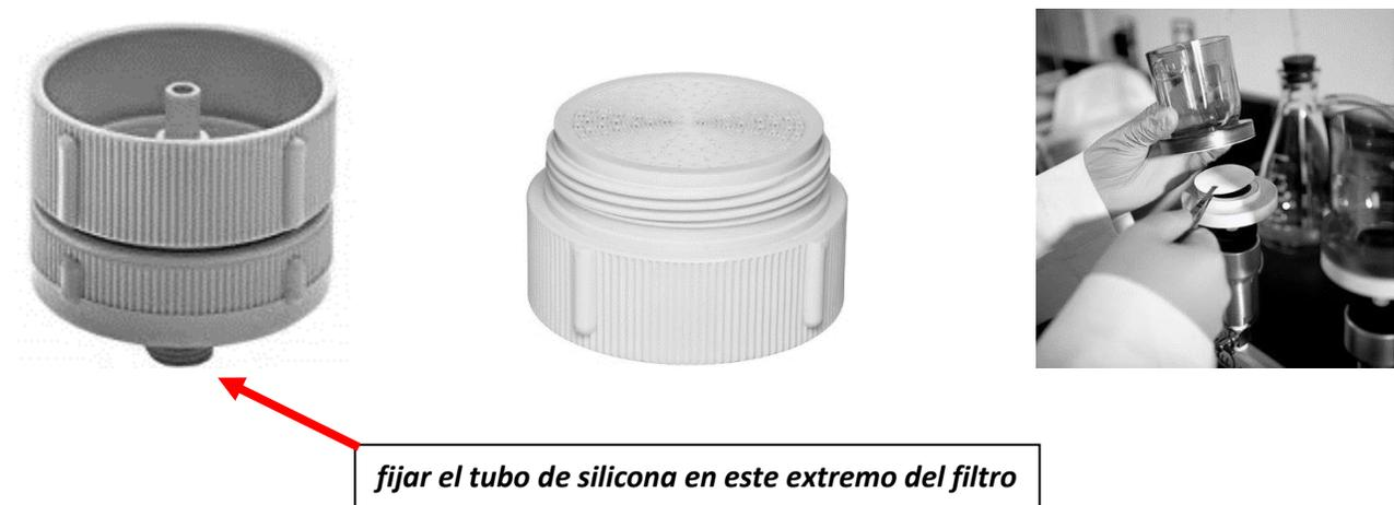
**Figura: (izquierda)** portafiltro Swinex con dos secciones atornilladas. El tubo de entrada / jeringa está conectado a la parte inferior (ver la foto); **(medio)** portafiltro Swinex con la sección de retención del filtro abierta; **(derecha)** Las pinzas se utilizan para colocar y retirar el filtro en el portafiltro.
