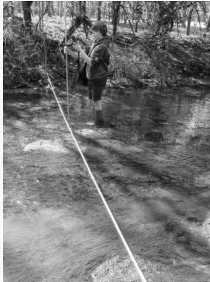
Fig 1. Configuración del medidor de flujo y la línea de etiqueta con cinta métrica (derecha) (Eustace Barnes)
